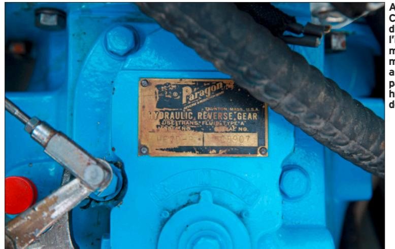
Accouplé au V8 Chris-Craft d'origine, l'inverseur mécanique monté d'usine a été remplacé par un modèle hydraulique plus doux à l'usage.
